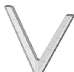
图 7.3.4-6 混凝土浇筑完成后, 拆除第六节模板, 完成V型柱浇筑
